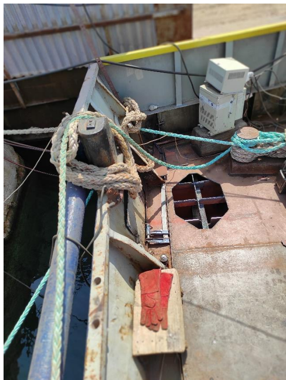
(ζ) Πρυμναίο κατάστρωμα Άνοιγμα πελμάτων A-Frame
