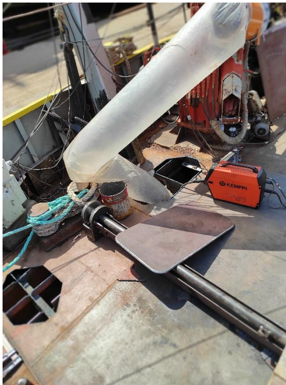
(ζ) Πρυμναίο κατάστρωμα Άνοιγμα πελμάτων A-Frame
