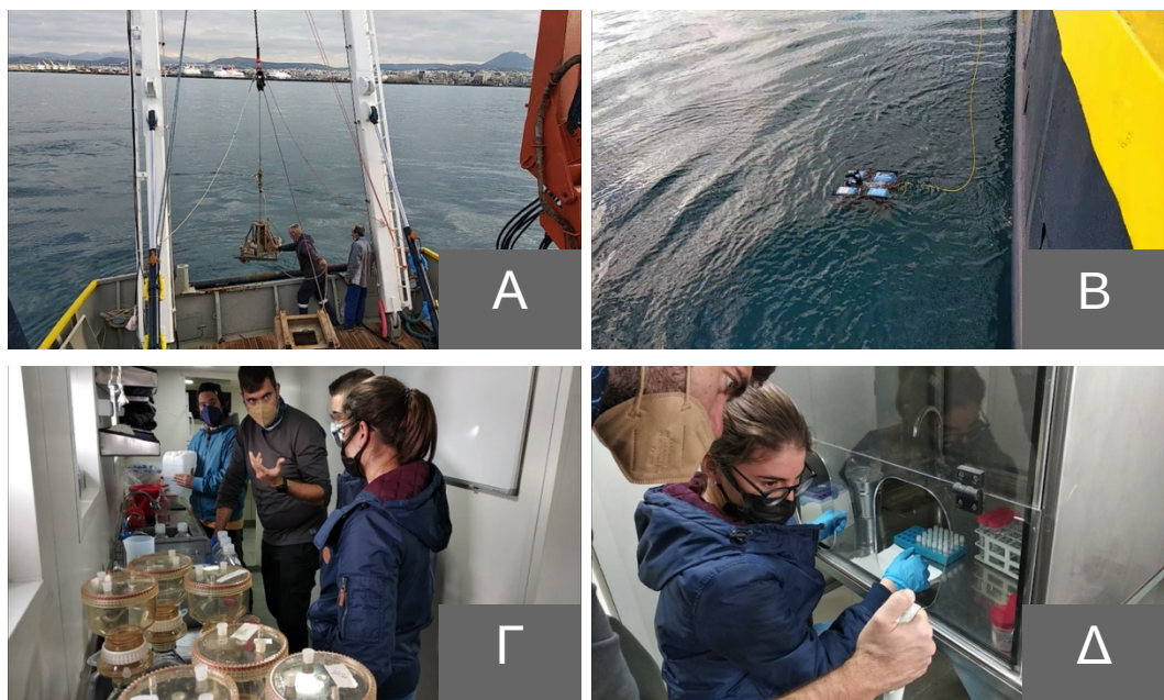
Εικόνα 3. Όργανα και δειγματολήπτες που χρησιμοποιήθηκαν κατά την ωκεανογραφική αποστολή: Α. Ο δειγματολήπτης Smith & McIntyre; Β. Το ρομποτικό όχημα (ROV) του Εργαστηρίου Οικολογίας του Τμ. Βιολογίας του Παν/μίου Κρήτης; Γ. Διάφορες συσκευές φιλτραρίσματος νερού; Δ. Χειρισμός δειγμάτων στο νέο απαγωγό του Ω/Σ ΦΙΛΙΑ.
