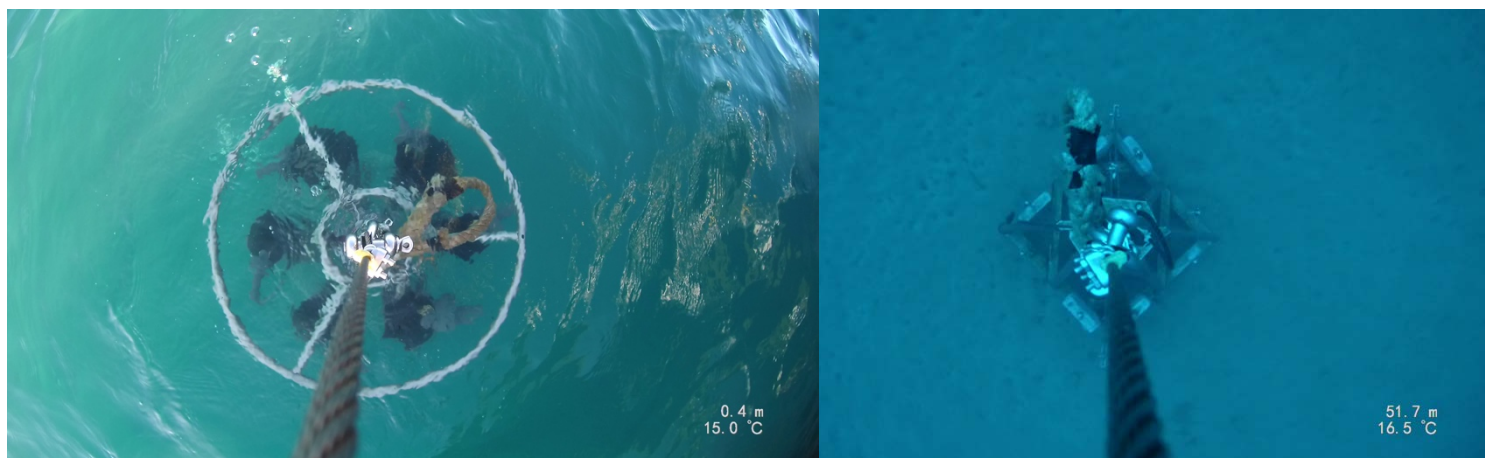
Εικόνα 4. Φωτογραφίες δειγματοληψίας νερού με Rosetta και ιζήματος με το δειγματολήπτη Smith & McIntyre
