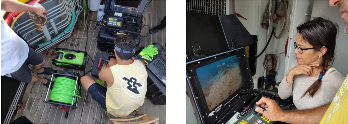
Εικόνα 2. Εγκατάσταση και χειρισμός του ROV Teledyne Seabotix LBV 200-4 στο
