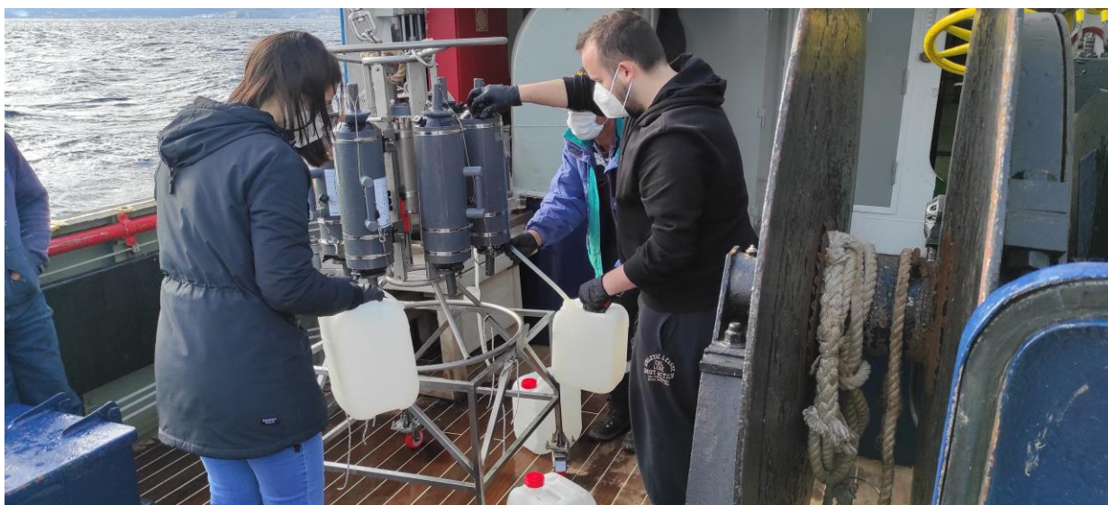
Εικόνα 1. Συλλογή δείγματος από τον κόλπο του Αγίου Νικολάου, πάνω στο Ε/Σ Φιλία με την χρήση των φιαλών Niskin (credits: Ιορδάνης Μαγιόπουλος)
