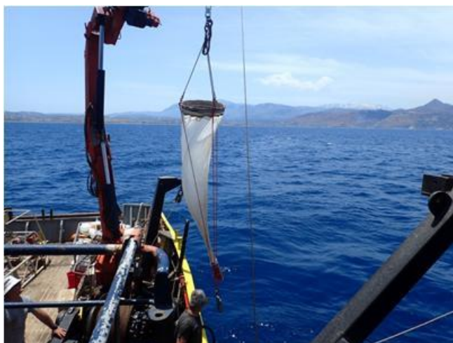
Εικόνα 2.2.9. Λήψη δειγμάτων μακροζωοπλαγκτού με χρήση πλαγκτονικού διχτυού
