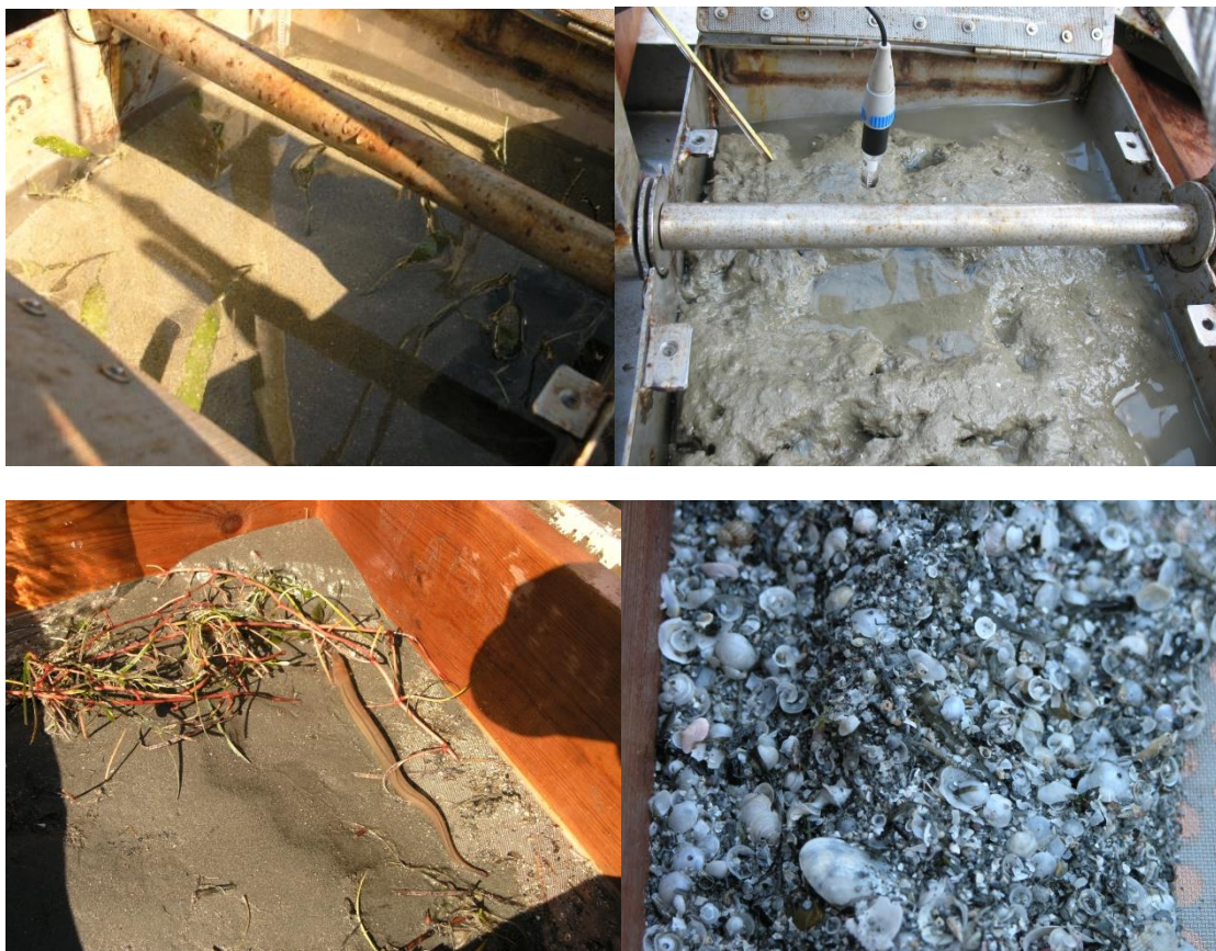
Εικόνα 2.2.7. Λήψη δειγμάτων ιζήματος με δειγματολήπτη τύπου αρπάγης (Smith McIntyre grab, δειγματοληπτική επιφάνεια 0.1m 2 )
