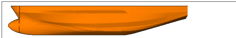
Σχήμα 5.4: Αναλυτική αναπαράσταση της αρχικής γάστρας με σύμμορφη απεικόνιση.
