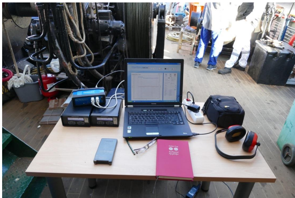
Εικ. 8: Σύστημα ελέγχου, ψηφιοποίησης και συλλογής μετρήσεων.
